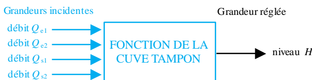
Figure 2.2 Schéma fonctionnel simplifié n°1
