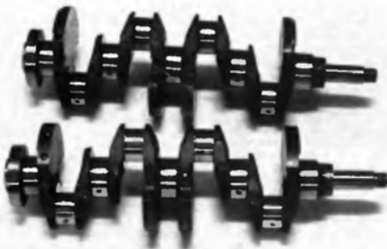
Une rectification excentrée des manetons (en bas) a permis de gagner 4 mm de course sur ce vilebrequin de Citroën Visa. Les contre-poids ont dû être usinés pour éviter le contact avec les pistons. Préparation Brunetti.
