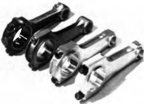
*En matière d'allègement de bielle, certains préparateurs n'hésitent pas à essayer des bielles en aluminium, entièrement usinées dans la masse. A l'arrière plan, la bielle d'origine en acier metric (au fond) et à côté, la même en acier forge. (Préparation Car-creff).*
