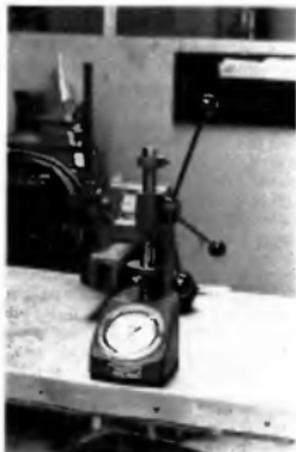
*L'appareil de contrôle des flexibilités (ou raideurs) des ressorts de soupapes. L'outil idéal pour sélectionner rapidement les meilleurs ressorts et au besoin égaliser leur terage.*
