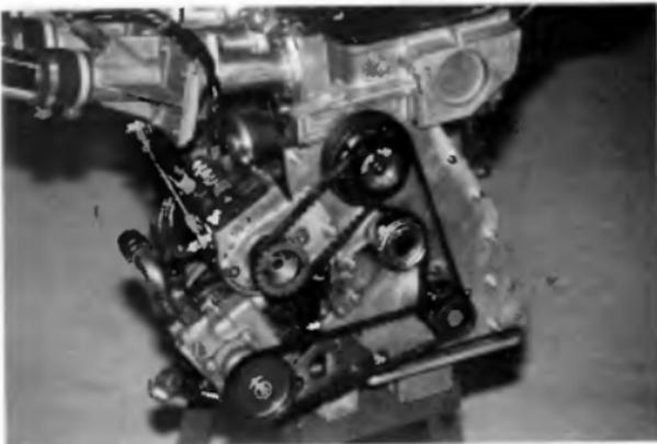
*Adaptation, sur bloc Renault 12G, d'une transmission par courroies crantées po l'entraînement de l'arbre à cames (latéral), de la pompe d'injection et des pompes à graissage par carter sec. La suppression de la commande d'origine par chaîne de l' nécessite la réalisation d'un carter de distribution spécifique (et étanche). A cet effet, bi et culasse ont été retouchés ici. (Préparation Carcreff, Gr. F).*
