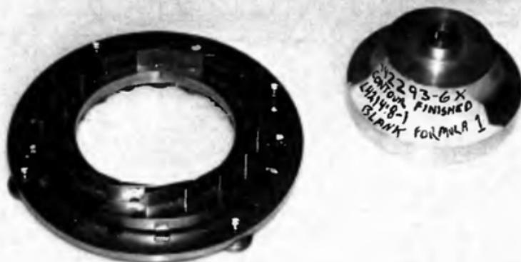
Mécanisme à pales orientables pour carter de turbine à géométrie variable, reste au stade de prototype sur les turbos du moteur F1 Renault. A droite, c'est dans ce bloc d'aluminium forgé qu'est entièrement usinée (!!!) sur machine à commande numérique, la roue du compresseur. Une petite fortune.
