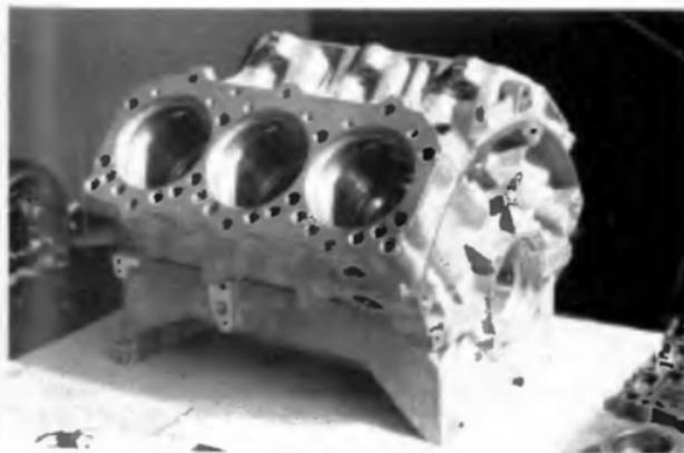
Hyper-rigide avant tout : le bloc aluminium « fermé » (à chemises humides) du moteur V6 Renault F1 (1500 cm<sup>3</sup> double turbo).
