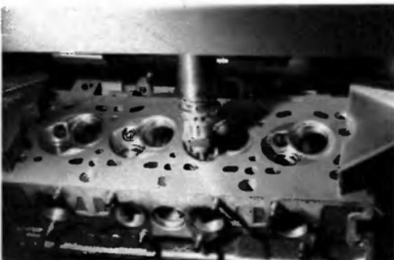
Le fraisage des sièges de soupape (cônes d'angle variable) peut s'effectuer manuellement à l'aide d'un outillage spécifique, ou, comme ici, sur machine entièrement automatisée
