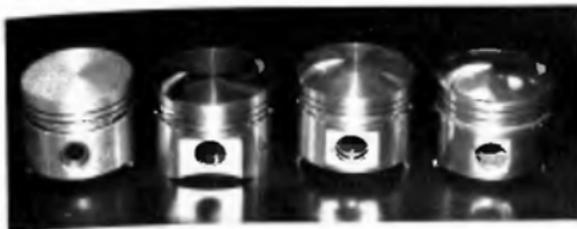
*De gauche à droite : Visa GT de série 1 360 cm<sup>3</sup> (moulé), préparateur libre Visa 1600 cm<sup>3</sup> (forgé), Visa 1000 pistes 1440 cm<sup>3</sup> (forgé), et piston moulé de Samba Gr. B (à noter l'encoche pour le passage de la bougie).*
