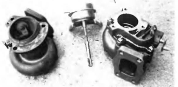
Exemples de carter de turbine (en fonte Ni-resist) de turbocompresseurs de série, avec clapet de décharge intégré. Au centre, le régulateur de pression à tirette à tige, qui agit sur le clapet. Le réglage de la longueur de la tige de commande conditionne directement la valeur de la pression de suralimentation.
