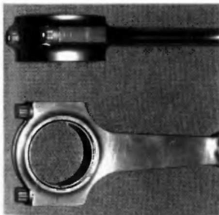
*La robustesse des bielles forgées en titane, dotées d'une large section en « H », saute aux yeux (Malra V12).*
