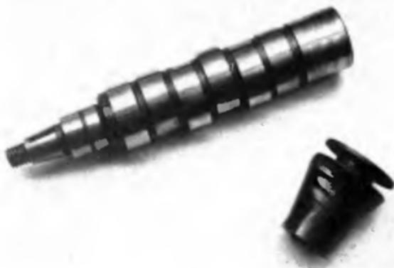
Une vue de l'arbre à cames de l'injection Kugelfisher du 6 cylindres BMW M1 et sa came tridimensionnelle.
