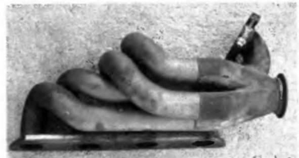
Collecteur « 4 en 1 » mis au point par Suemoto-Moteurs pour les R21 Turbo « Super Tourisme », comprenant une dérivation pour le raccordement de la waste-gate.
