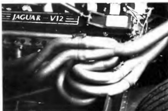
Sans aucun doute, l'une des plus belles réalisations acoustiques de ces derniers temps que ces splendides tubulures d'échappement qui équipent le V12 Jaguar Sport Proto, 4 collecteurs = 3 en 1 - regroupés en deux « Y », un par banc.
