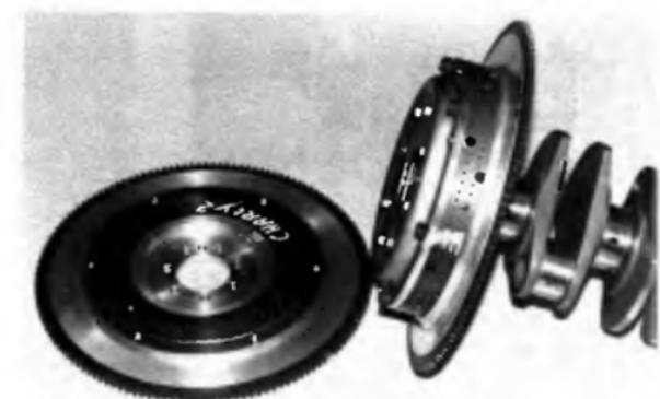
Volant moteur en aluminium avec friction et couronne de démarreur (très amincie pour réduire la ventilation) rapportées, pour moteur Renault Alpine Gr. F (préparation Carcreff).
