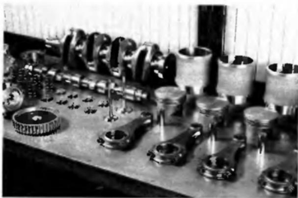
*Le quiete de l'assemblage n'est pas un vain mot lorsqu'on parle de réduction des frottements internes. La phase de pré-assemblage requiert organisation, propreté et grande rigueur. (Éléments de moteur de R21 Turbo Super Tourisme. Préparation Sodemo).*
