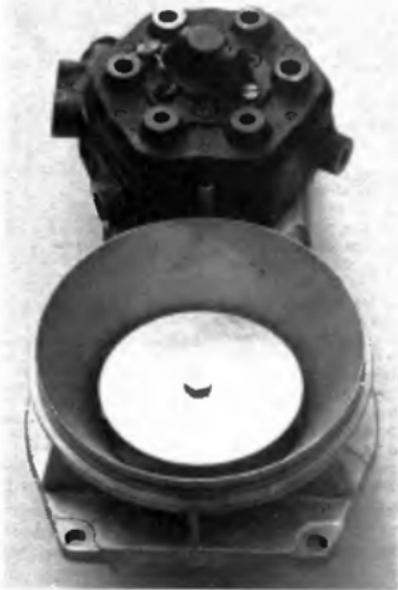
La loi de richesse d'un « K-Jetronic » peut être également modifiée en retravaillant la conicité des différents cônes du corps de débitmètre à plateau-sonde (voir texte). Un essai délicat pas du tout évident (préparation Pierre Ferry).
