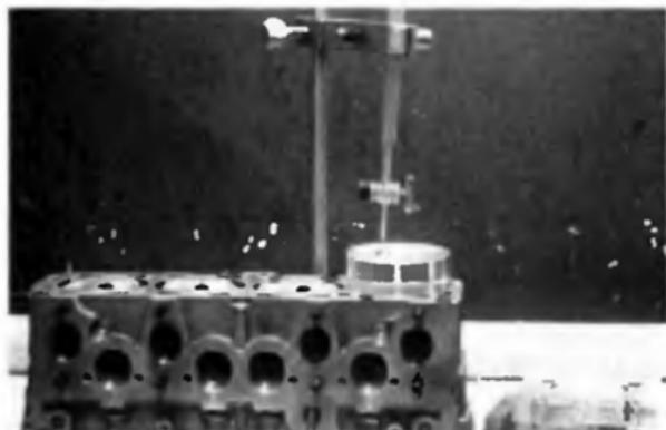
Mesure du volume des chambres à l'aide d'une pipette graduée et d'une plaque de plexiglas rigide. Cette dernière est percée de deux trous : l'un pour le remplissage du liquide, l'autre pour l'évacuation de l'air.
