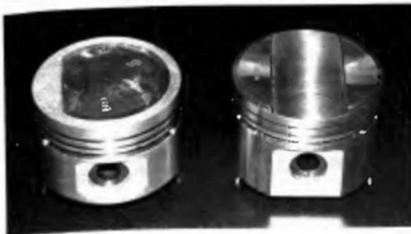
*Pistons de 205 GTI, pour la série (moulé) à gauche, pour une préparation Gr. A (forgé) à droite.*
