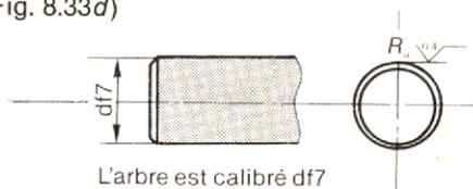
L'étranglement des bagues conduit aux ajustements suivants : sans épaulement H7f7 ; avec épaulement H8f7.
