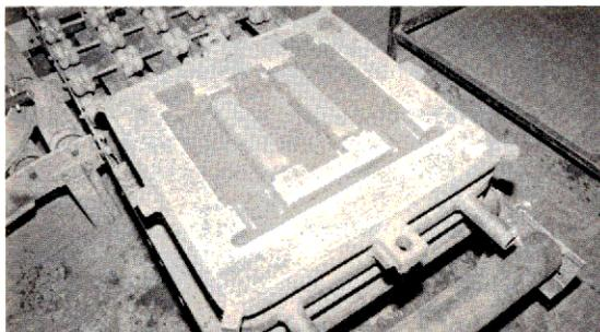
Fig. 5.08. — Châssis inférieur.
