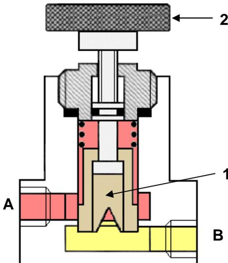
Des entailles en forme de **Vé** situées à la base du tiroir **1**, permettent un réglage progressif du passage du débit entre les orifices **A** et **B**.
