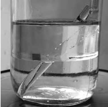
Fig. 1.4. Phénomène de réfraction. Tige de verre immergée dans un mélange eau/toluène. Le toluène, plus léger que l'eau, se trouve au-dessus.
