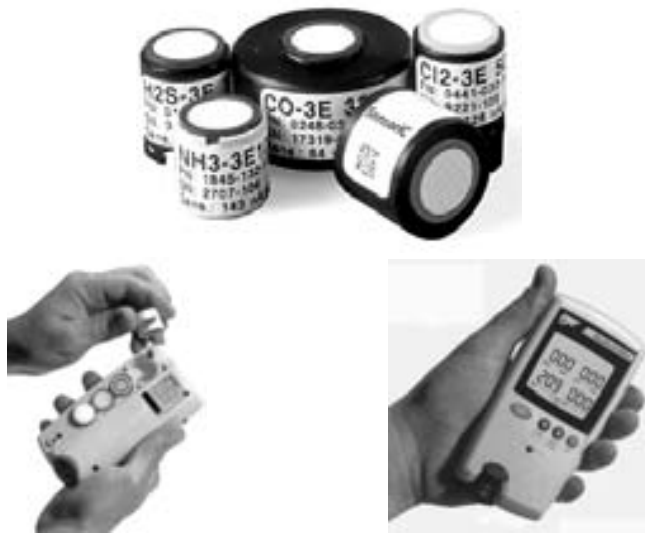
Figure 20.8 Capteurs ampérométriques pour gaz (Amperometric Gas Sensors). Assortiment de capteurs de la société ATMI Sensoric Div. (Ger.). Modèle GasAlertMax3-DL de la société BW Technologies (Can.); La photo centrale montre le compartiment où sont rangés les 4 détecteurs spécifiques aux 4 gaz détectables simultanément. Après avoir franchi une barrière de diffusion spécifique afin de ne pas saturer le capteur, le gaz est oxydé (CO, H 2 S, NO, H 2 , HCN) ou réduit (Cl 2 , NO 2 ) en présence de l'électrolyte au contact d'une électrode dite de travail de grande surface.
