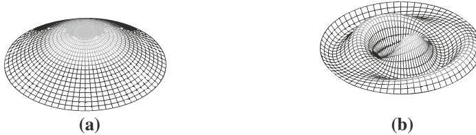
Figure 4.11 Exemples de vibrations d'une membrane circulaire. (a) mode fondamental de vibration n = 0, p = 1 ; (b) exemple de mode n = 1, p = 3 .
