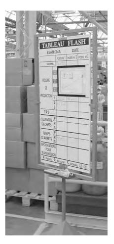
Le panneau flash est un panneau au poste de travail, à proximité du/des opérateurs afin de ne pas générer de gaspillage en déplacement.
