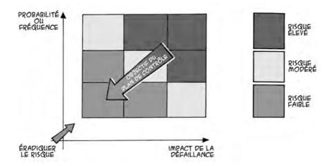
L'AMDEC processus est particulièrement utilisé pour assurer l'efficacité du démarrage des nouveaux flux, mais peut s'appliquer efficacement sur des flux anciens.
