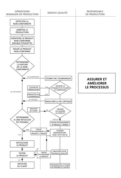
Lors d'un contrôle ou d'un autocontrôle ? Que se passe-t-il si l'on détecte une non-conformité ?
