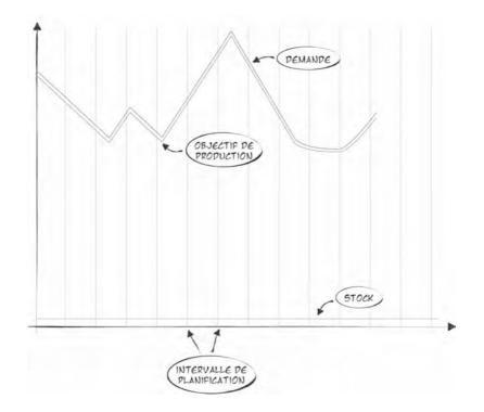
À défaut de pouvoir adapter parfaitement la capacité à la charge, vous devez essayer de niveler la production en actionnant des leviers de capacité, vers le haut ou vers le bas.
