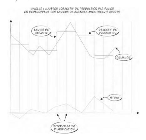
Lean dit que les stocks (ici sur avance de production) sont un gaspillage. L'avance de production est un gaspillage sélectif : c'est cela, ou ne pas satisfaire le client. C'est cela, ou se payer une surcapacité (gaspillage « attente » ?) dont on n'a pas besoin la plupart du temps.
