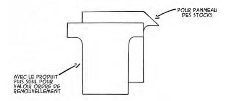
Une fois l'antécédent fabriqué, pour l'exemple un produit A, le produit A retourne physiquement dans le stock, à l'emplacement B4 par exemple. Le produit A garde sur lui l'étiquette non biseautée. Et L'étiquette biseautée se positionne sur le tableau des stocks, à la croisée de la ligne B et de la colonne 4.
