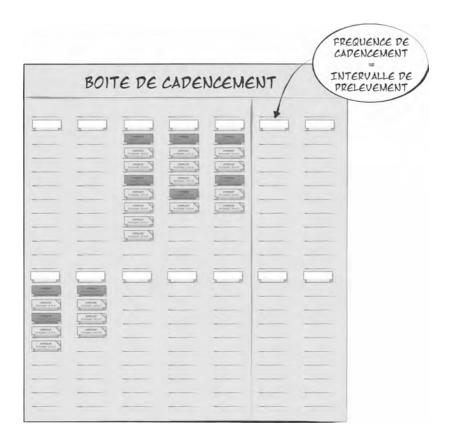
Ce panneau est utilisé pour planifier la production sachant qu'un lot peut être avancé dans le planning, mais ne peut être reculé car il est initialement placé à sa date au plus tard.
