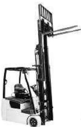
Le **chariot à mât rétractable** est capable de lever des palettes sur une hauteur de plus de 10 mètres et peut circuler dans des allées étroites.
