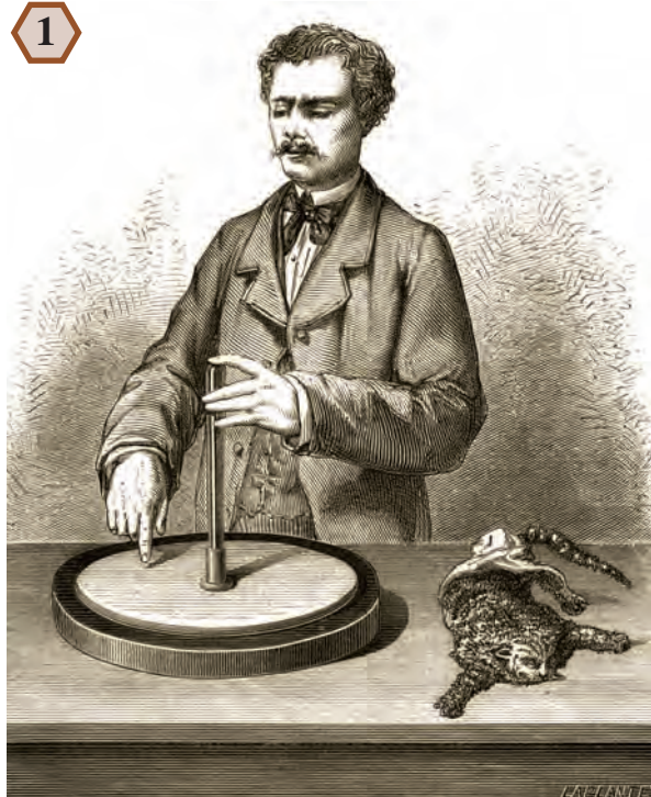
Électrophore à gâteau de résine avec un manche isolant en verre, selon une illustration du 19 e siècle.
