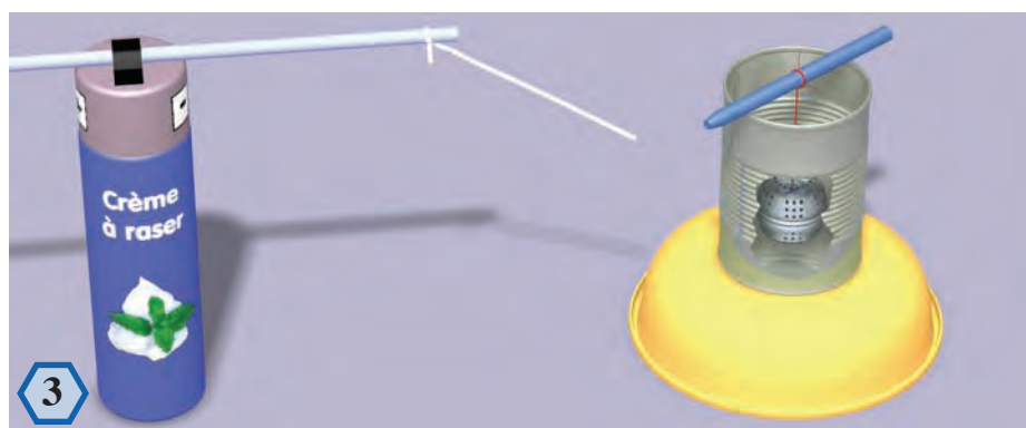
Introduis le contenant à infusion, chargé positivement par ton électrophore, dans la boîte de conserve, sans que le contenant à infusion touche à la boîte. Tu verras alors que la bandelette de téflon de ton détecteur est attirée par la boîte.
