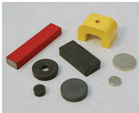
Variété d'aimants artificiels. À gauche, des aimants faits de lames ou de rubans d'acier aimantés, en forme de barreau et de fer à cheval, munis d'armatures en fer aux pôles, tels qu'on les fabriquait au 19 e siècle. À droite, des aimants modernes en alnico (rouge et jaune), en ferrite (gris-brun foncé) et au néodyme (argentés).
