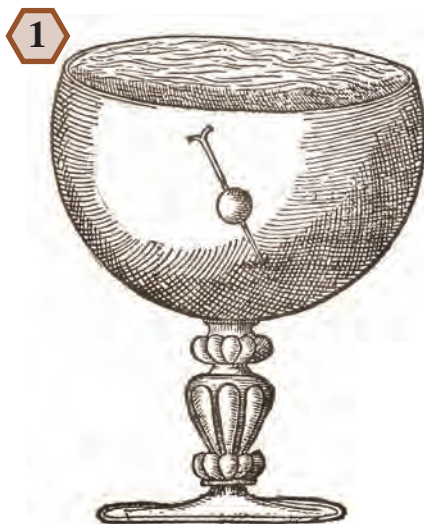
L'expérience de l'aiguille aimantée flottant dans un verre, réalisée par Norman.
