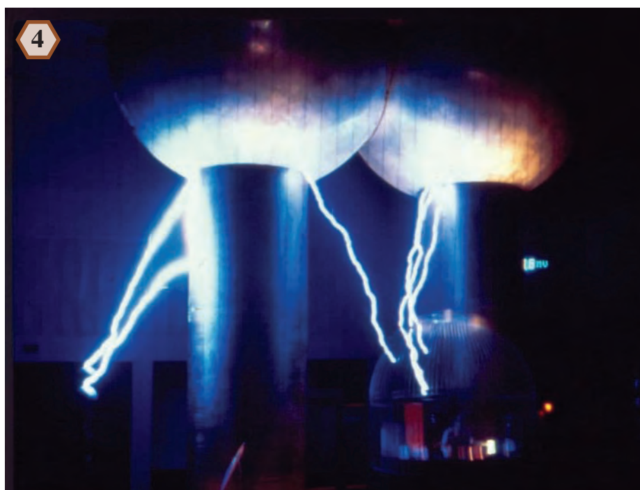
Démonstration d'éclairs artificiels produits par la machine de Van de Graaff, au Theater of Electricity du Museum of Science, à Boston. Une cage de Faraday protège l'animateur. La machine et la cage de l'animateur sont entourées par une gigantesque cage de Faraday faite de câbles métalliques, afin de protéger les spectateurs (gracieuseté du Museum of Science).
