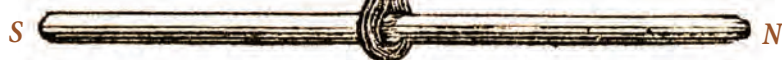
Coulomb suspend des barreaux aimantés et mesure leur fréquence d'oscillation. Plus les oscillations sont rapides et plus l'aimantation du barreau est importante.
