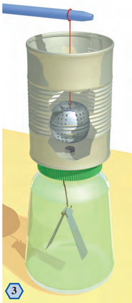
Version domestique de l'expérience de Faraday, avec un électroscope à cylindre.
