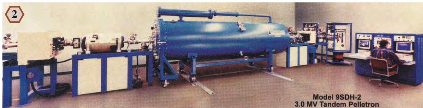
Un accélérateur Pelletron de la compagnie National Electrostatics Corporation produisant trois millions de volts et faisant partie d'un système d'analyse perfectionné des atomes. L'accélérateur est à l'intérieur du caisson bleu (gracieuseté de National Electrostatics Corporation).
