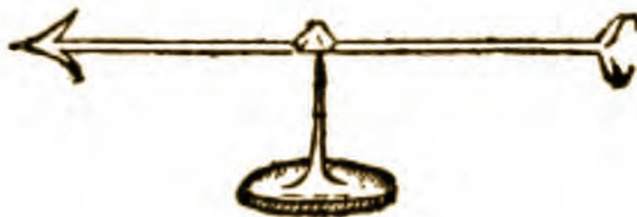
Illustration d'un versorium, tirée du livre de Gilbert, montrant cet instrument qu'il a inventé et utilisé pour détecter les faibles forces d'attraction électriques.
