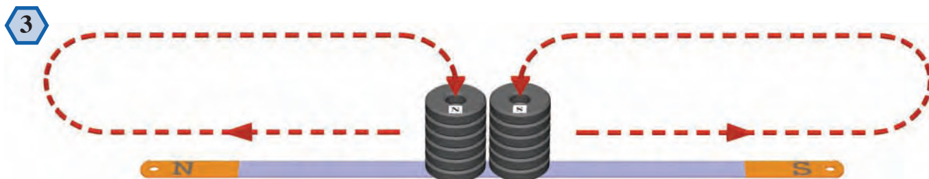
Méthode dite de la « double touche », utilisée pour aimanter une lame de scie à métaux en acier d'environ 30 cm.
