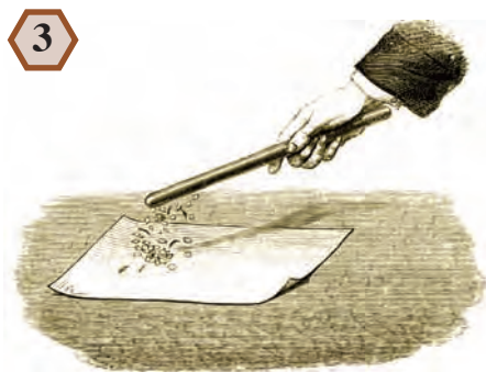
C'est l'induction électrostatique qui fait en sorte que des bouts de papier non électrisés soient attirés par un barreau de verre frotté.
