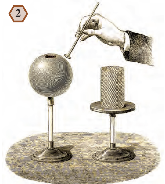
À l'aide d'un petit disque métallique fixé à un manche isolant, on prélève de l'électricité à différents endroits sur des contenants métalliques creux électrisés et isolés par des tiges de verre. On présente ensuite le petit disque à un électroscope comme le détecteur à fils (épisode 2-4) pour vérifier s'il est électrisé. On démontre ainsi que les charges électriques se retrouvent seulement à l'extérieur.
