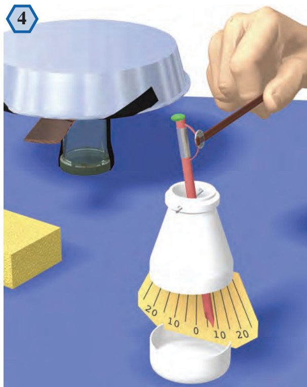
À l'aide de cet électromètre simple et sensible, tu pourras vérifier comment se répartit l'électricité sur le plateau électrisé de ton électrophore ( épisode 2-7 ).
