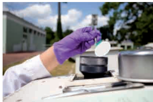
Prélèvements des aérosols sur filtre.
