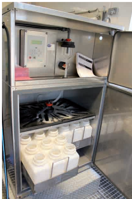
Hydrocollecteur pour les prélèvements d'échantillons à mi-rejet.
