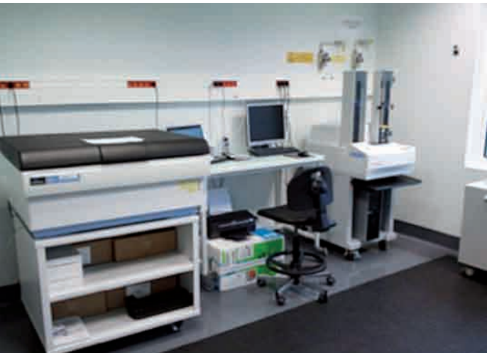
Scintillateur bêta pour la mesure du tritium (à gauche) et compteur proportionnel (à droite) au laboratoire « Effluents ».
