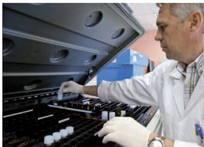
Mesure du tritium par scintillation liquide.
