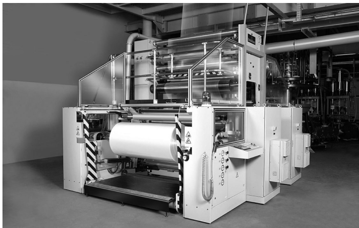
Figure 4.16 – Enrouleur de film Reifenhäuser.
