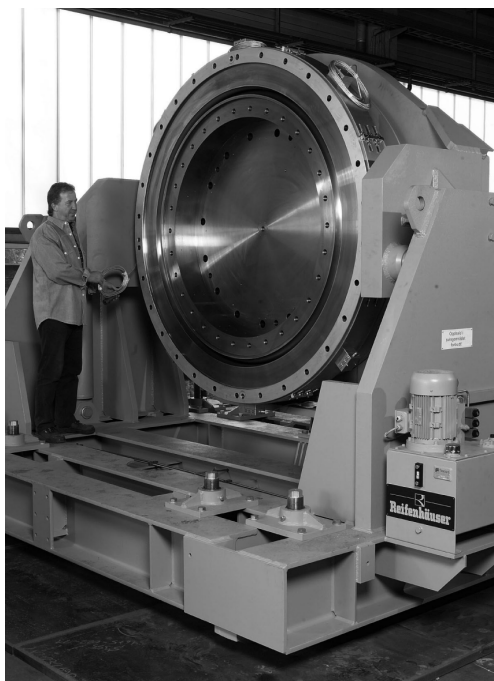
Figure 4.11 – Exemple de filière pour tube de grand diamètre (avec l'aimable autorisation de Reifenhauser).
