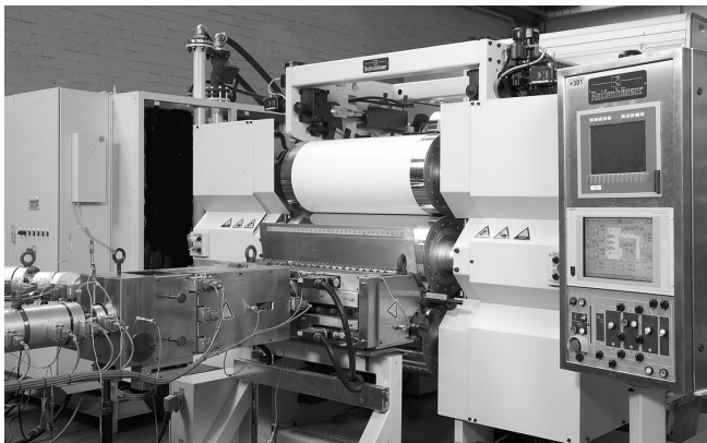
Figure 4.19 – Exemple d'une ligne de fabrication de feuilles de Reifenhäuser.
