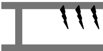
Figure 4.10 – Principe de profilés à talon rigide et lèvres souples fabriqués par coextrusion.
