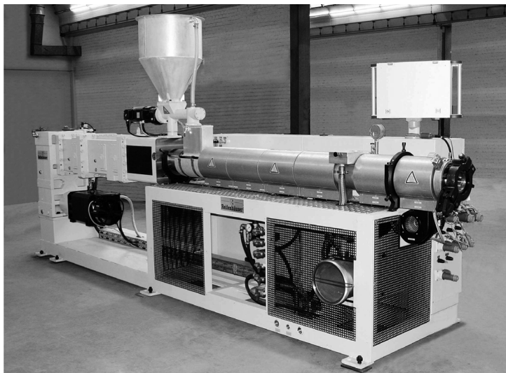
Figure 4.1 – Extrudeuse Reifenhäuser (avec l'aimable autorisation de Reifenhäuser).
