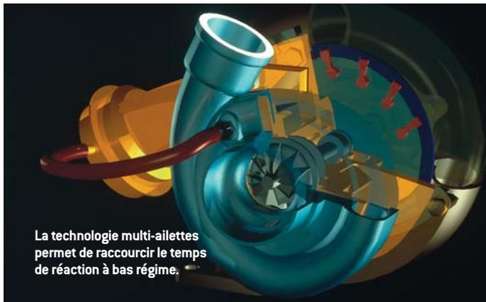
La technologie multi-ailettes permet de raccourcir le temps de réaction à bas régime.
