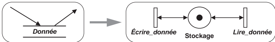
Figure 2.48 – Traduction d'une unité de stockage de la méthode SA-RT par un réseau de Petri.
