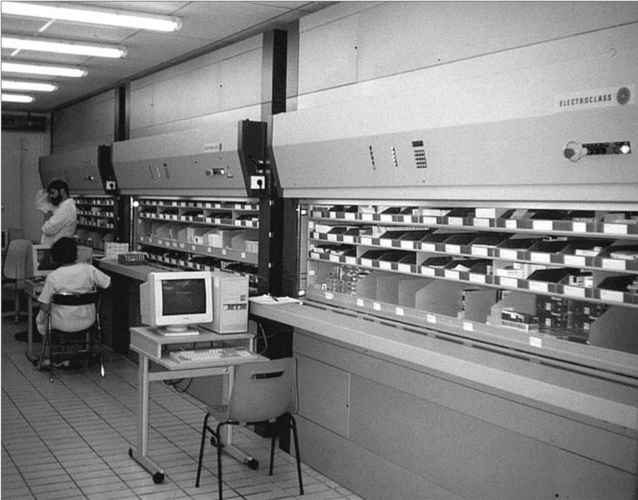
Le stockage rotatif exploite toute la hauteur des locaux – comme un rayonnage vertical – mais la mise à disposition des produits se fait toujours à hauteur d’homme. En outre, il permet de stocker les pièces en optimisant la hauteur sans aucune perte d’espace et procure ainsi une capacité de stockage maximale pour un encombrement au sol minimal. Ce système est particulièrement adapté pour le stockage de petites pièces.
